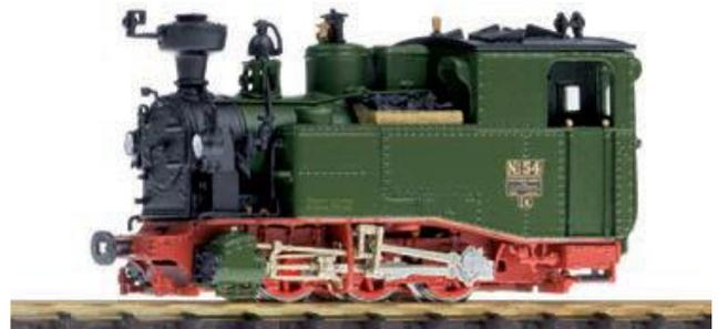
*Sächsische I K in der Nenngröße H0e für Gleise mit einer Spurweite von 9 mm*
