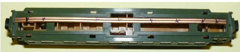
▲ Hier ist für die Waggonbeleuchtung die PCB-Leiterbahn bereits passend geschnitten
