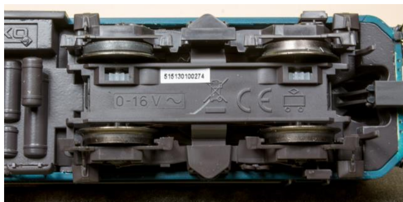
Freiliegende Zahnräder sind für den Service praktisch, aber auch immer eine Verschleißquelle
