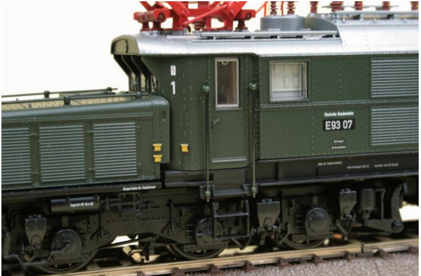
475 Gramm brachte das Modell der E93 auf unsere Waage. Mehr als genug Gewicht, um mit dem starken Motor und der guten Kraftübertragung auch lange Güterzüge über jede Modelleisenbahn-Anlage zu ziehen.
