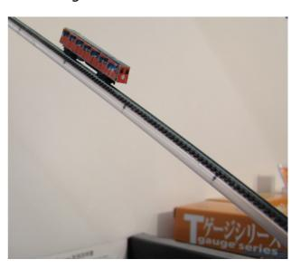
Durch die magnetischen Radsätze sind mit den angetriebenen Mittelwagen auch, Bergbahnen" mit einer 45-Grad-Steigung kein Problem
