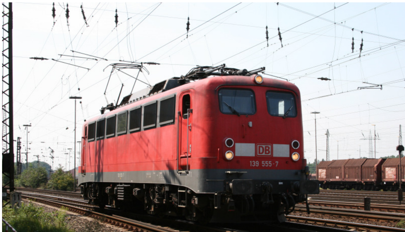
BR 139 555 mit der klassischen Stellung Panto in Fahrtrichtung hinten am Fahrdrabt anliegend
