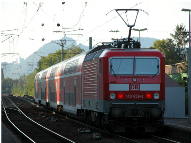
BR 143 856 als Schublok für einen Regionalexpress: Der in Fahrtrichtung letzte Panto versorgt die Einheit mit Strom
