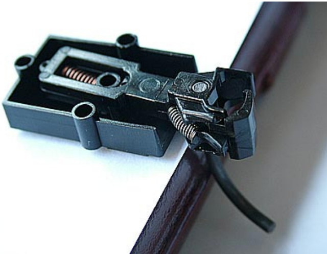
Montierte Spur 1-Kadee-Kupplung ohne Abdeckplatte
