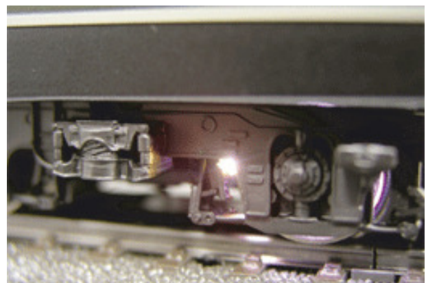
Die Mini-LED blitzt auf und simuliert einen beeindruckenden Funkenflug an der Bremsscheibe einer Lok
