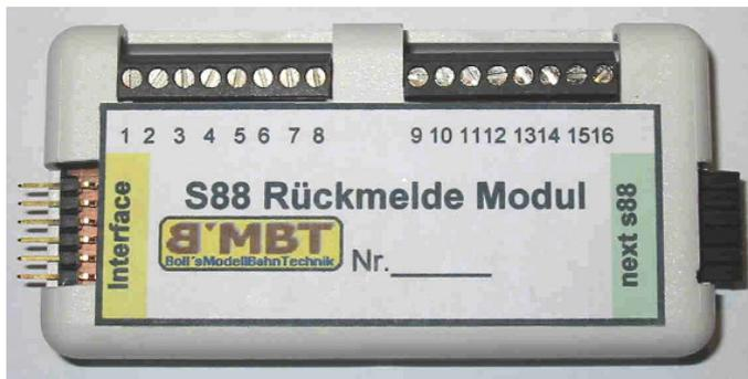
Der S88-Rückmelde-Decoder von G. Boll ist für die Rückmeldung von Kontakten bzw. Kontaktstrecken von der Modellbahnanlage zum Steuerungssystem konzipiert, kann aber zudem alle Taster, Schalter und Reedkontakte melden, die das Rückmeldekontakt-Signal gegen Masse schalten
