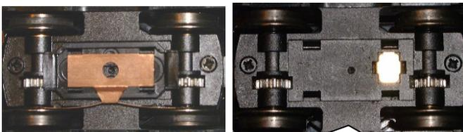
Drehgestell ohne Haftreifen, Radschleifer entfernt. Hier wird der Mittelschleifer in die vier Schlitze eingeclipst.
