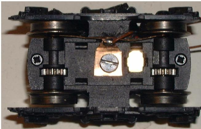
*Umgebauter Radschleifer mit bereits angelötetem braunem Kabel und dem gekürzten Kontaktblech des Radschleifers*
