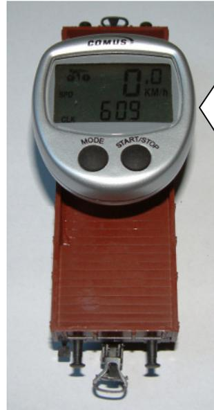
Einfacher geht es nicht: Die Anzeige schaltet sich automatisch ein, wenn der Waggon losrollt. Dieser Fahrradcomputer schaltet sich nach 3 Minuten Inaktivität auch automatisch wieder aus.
