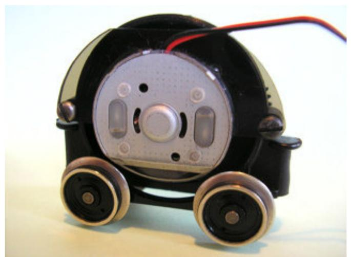
Umbau-Motorsatz ModelTorque MLF-20 für alte Lima „Pfannkuchen-Motoren“
