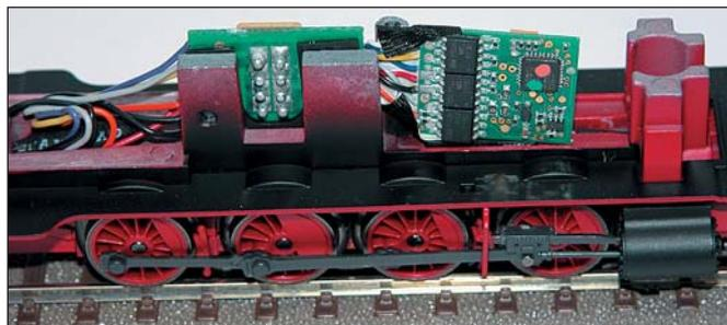
Die geöffnete AC/Mittelleiter-Version der Piko 55er: In der Mitte erkennen Sie die achtpolige Schnittstelle nach NEM 652, rechts daran angeschlossen den Digitaldecoder
