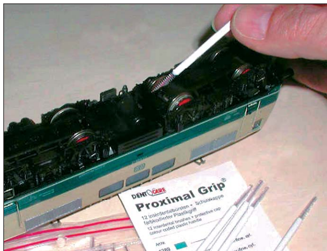
Bei der Schmutzentfernung mit der Interdentalbürste sparen Sie in manchen Fällen das Öffnen der Lok
