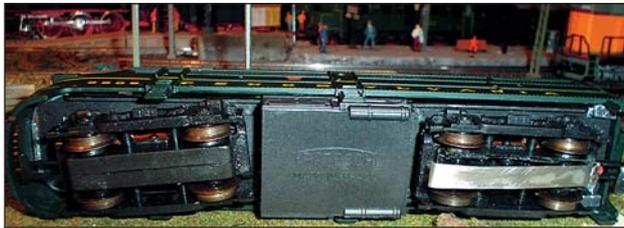
Die Drehgestelle der Frateschi FA-1 mit einem montierten Selbstbau-Schleifer, der am hinteren Drehgestell befestigt ist
