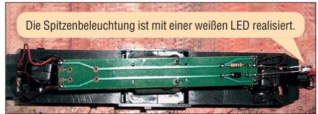
Die Platine des Modells mit dem roten Kabel (links), das zu dem Schleifer führt. Unter der Platine befindet sich der Mabuchi-Motor in der Fahrzeugmitte sowie die zwei Schwungmassen
