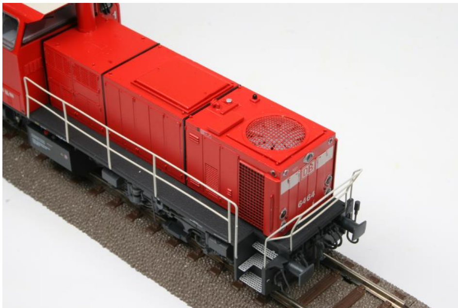
Geätzte Lüftergitter und Rangiertritte, Handläufe aus Metall und ein echtes Lüfterrad gehören zu den vielen Feinheiten der Rocky-Rail-Lok
