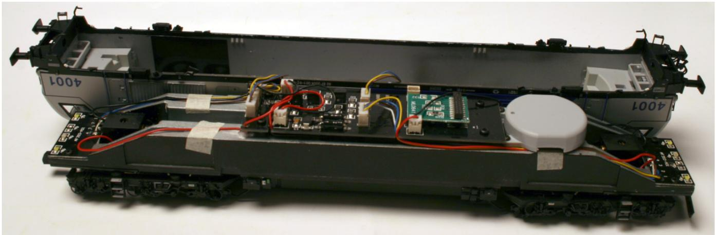
Die aufgeräumt wirkende Innenansicht der EURO 4000 mit dem aufgesteckten ESU Digitaldecoder
